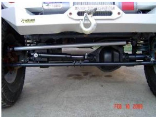
Если тяги расположены под углом, то при возникновении усилий вдоль моста только часть усилия распределяется вдоль моста, а остальная часть переходит в усилие, которое стремится поднять или опустить мост. Т.е. тяги хуже справляются со своей задачей и возникают паразитные силы, которые влияют на положение моста на дороге.
