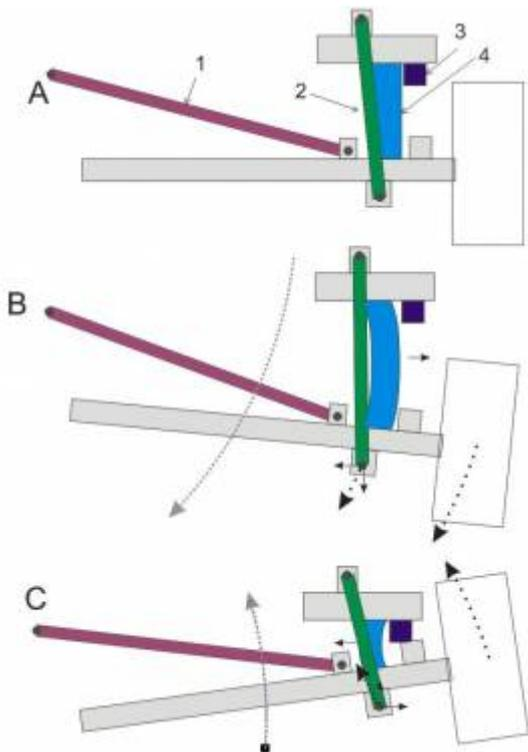
На схеме: **A** – подвеска в штатном состоянии, на стоящей машине **B** – подвеска при максимальном разжатии (отбое) **C** – подвеска при максимальном сжатии. 1 – тяга панара 2 – амортизатор 3 – отбойник 4 – пружина
