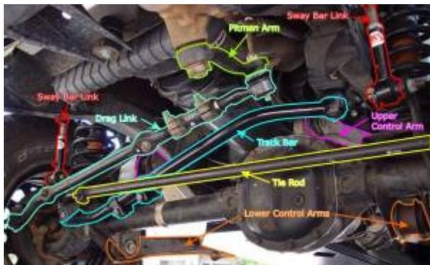
**Sway Bar Link** Стойки (или линки) стабилизатора. Соединяют железяку стабилизатора, который закреплен на раме, с чулком моста.
