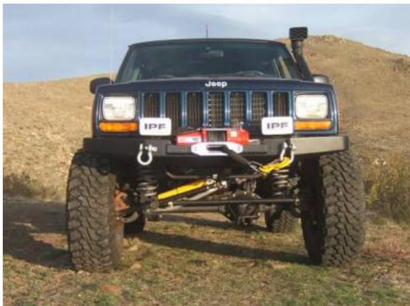
Чем больше установленный лифт, тем больший угол образуется между тягами и мостом. При изменении угла тяг, паразитные силы, которые начинают действовать на мост, увеличиваются,
