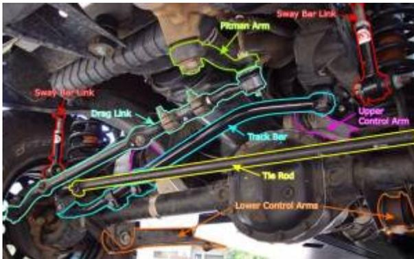
**Sway Bar Link** Стойки (или линки) стабилизатора. Соединяют железяку стабилизатора, который закреплен на раме, с чулком моста.
