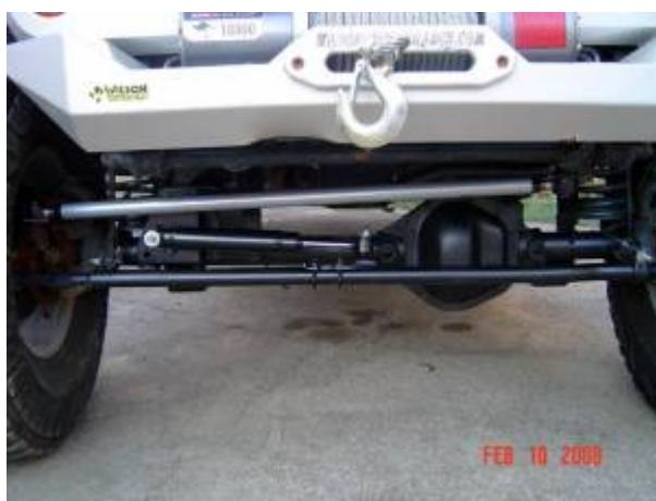
Если тяги расположены под углом, то при возникновении усилий вдоль моста только часть усилия распределяется вдоль моста, а остальная часть переходит в усилие, которое стремится поднять или опустить мост. Т.е. тяги хуже справляются со своей задачей и возникают паразитные силы, которые влияют на положение моста на дороге.
