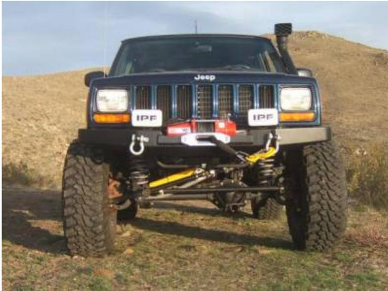
Чем больше установленный лифт, тем больший угол образуется между тягами и мостом. При изменении угла тяг, паразитные силы, которые начинают действовать на мост, увеличиваются, а полезные, которые направлены вдоль моста, уменьшаются.
